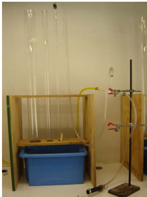
Figura N° 3.5.7. Equipo de medición de la permeabilidad.
