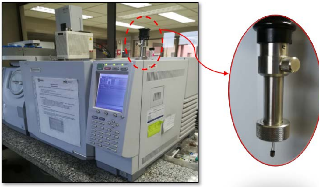
Figura 8. Pirolizador EGA PY330D (Frontier, Lab) conectado en línea a un GC-2010 Plus (Shimadzu) equipado con un detector de masas (QP2010 ultra, shimadzu) / Sistema de inyección de la muestra.
