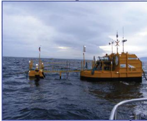
Figura 4.19.- Dispositivo OE Buoy.
