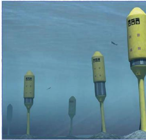
Figura 4.11.- Dispositivo Arquímedes Wave Swing.
