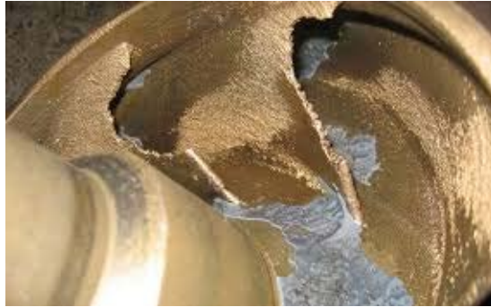
Figura 2-6 Cavitación en el rodete de una bomba
