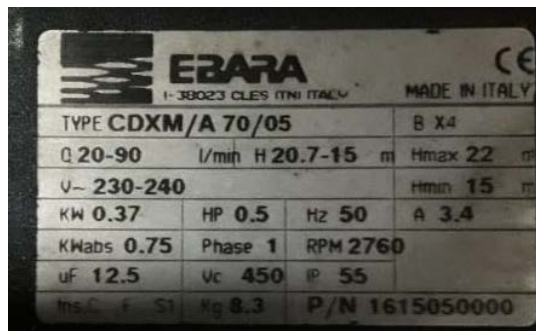
Figura 3-2 Placa de la bomba.
