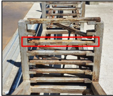
Figura 4.0. Disposición de las barras de soporte de la madera en el carro.
