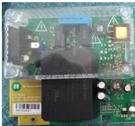
Fig. 2.3.3 Etapa de acoplamiento a la red y regulación
