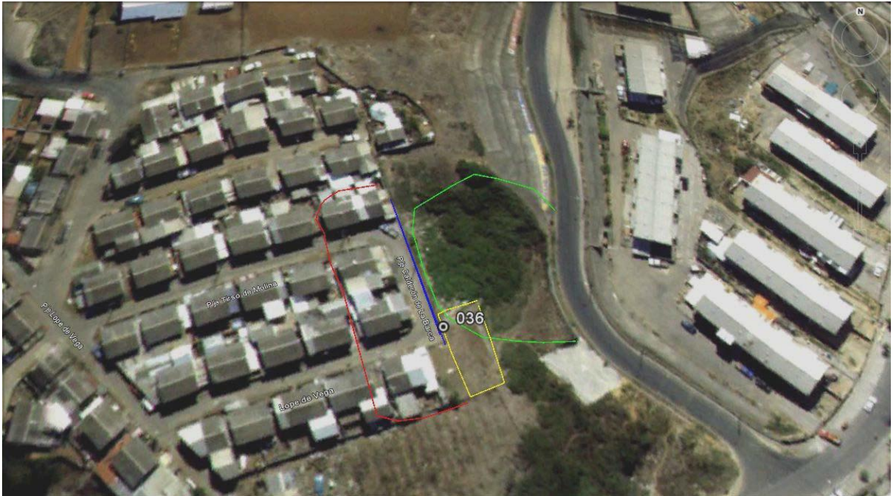
Figura. H1. Se observa imagen de sector afectado en Villa Los Escritores. El polígono rojo marca las viviendas muy dañadas por agrietamiento y asentamiento del terreno. En amarillo sector demolido varios años atrás por asentamientos y deslizamientos. La línea azul indica la dirección preferencial N25/W del conjunto más frecuente de grietas. La flecha amarilla indica el sentido del desplazamiento. En verde se demarca el talud intervenido para rellenos de construcción de Villa Modelo.
