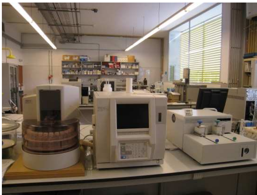
Figura 1.3.4, Analizador de carbono orgánico total. Modelo actual de analizador automático en el cual se utiliza la oxidación química para determinar el COT en agua y en aguas residuales.
