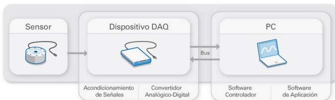
Figura 5.1 Componentes de un sistema de adquisición de datos
