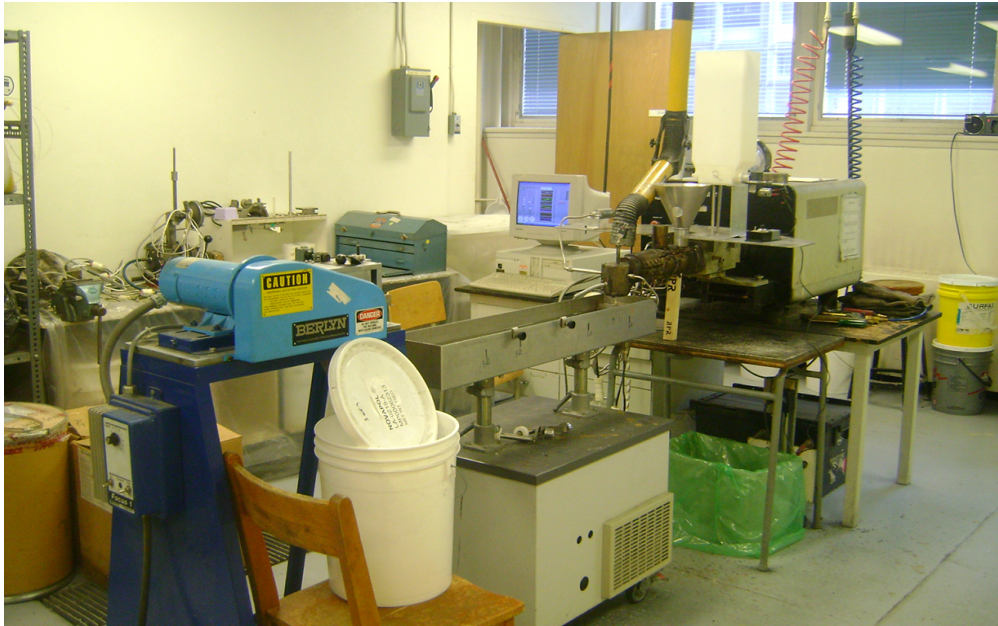
Figura V.6 Equipo de extrusión, laboratorio de ingeniería química. Universidad de Laval, Quebec, Canadá.
